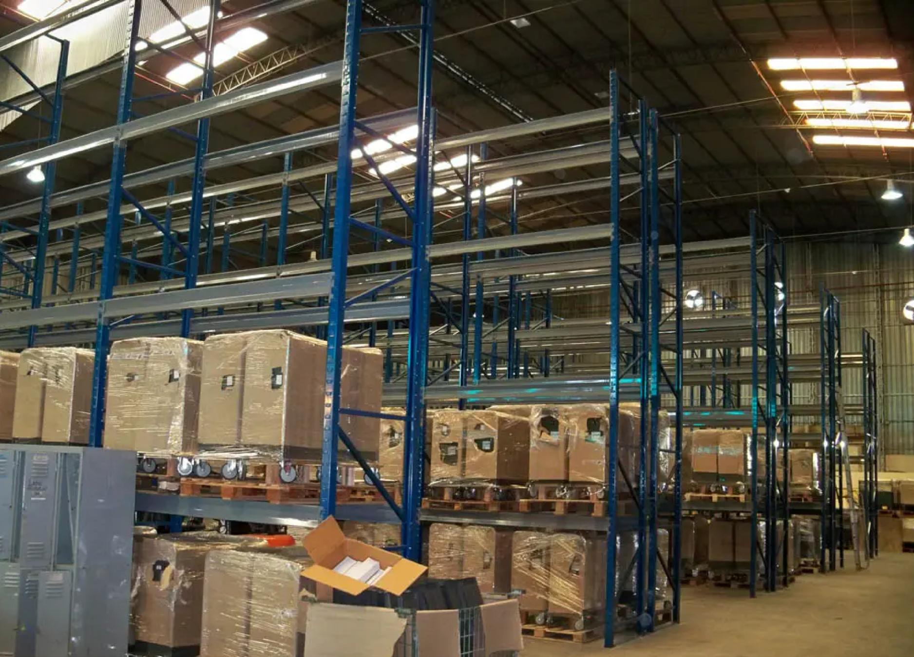
Hay variedad de vigas que soportan diferentes pesos, éstas son construidas con grapas en los extremos para fijarse a los bastidores. El armado de los bastidores, cuyos componentes son columnas, riendas y travesaños, se realiza íntegramente con bulones, evitando así, la utilización de soldaduras.
